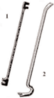
Pinças 1 : per cindrar las armaduras de fèrre o arpa 2 : per desmargar los cofratges
